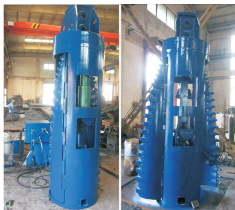
图7 TGK800/1600型集土式扩底钻具收翼和扩翼状态
