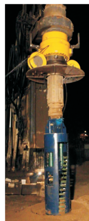
图10 钻具收翼状态
