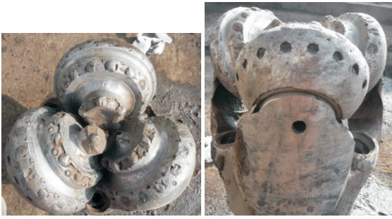
图 4 \text{O}311.2 \text{ mm} HJTS547GK 型钻头磨损情况
