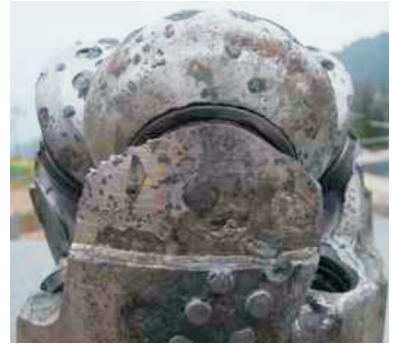
图 5 钻头掌背上形成上小下大的台肩形貌
