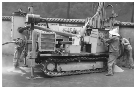
图4 采取除尘装置后钻进照片
