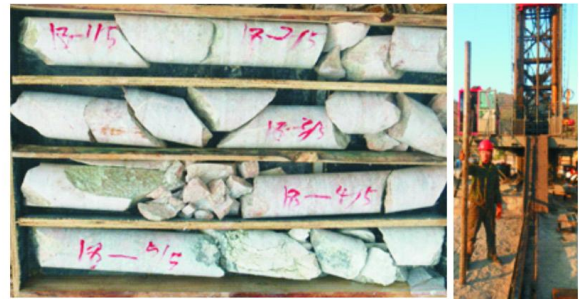
图8 SYZX122型绳索取心液动锤钻具取出的岩心
