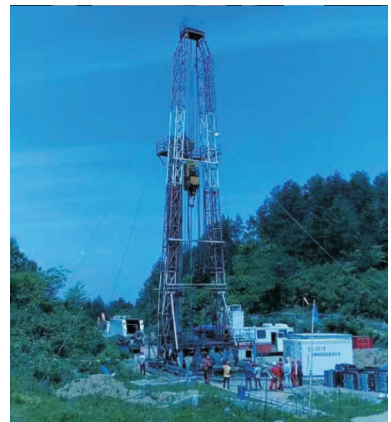
图1 XD-30DB型交流变频顶驱岩心钻机
