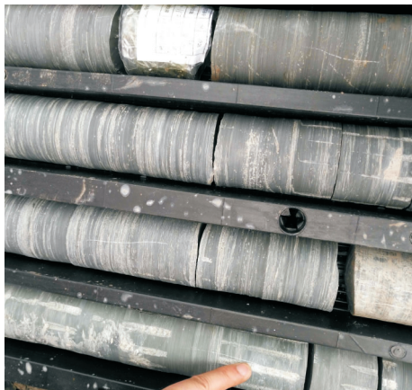
图 4 卡簧点焊后岩心上形成的拉痕
