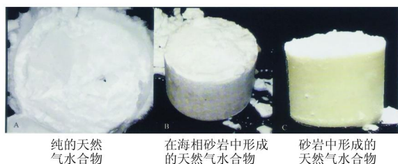
图 20 美国 NETL 实验室 1 L 合成小室中制成的水合物样品
