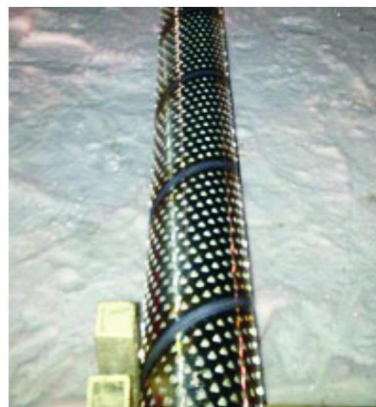
图24 防止地层砂粒进入生产试验井的防砂网
