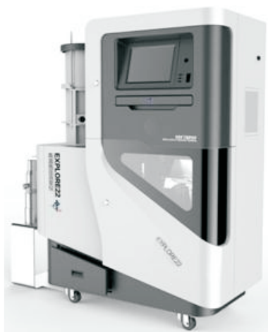
图3 超高压高低温钻井液流变仪整机示意图
