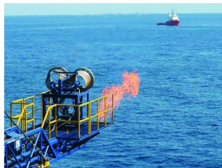
图 24 日本南海海槽天然气水合物试采生产出的甲烷气体在燃烧
