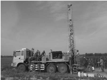
图 2 车装式全液压钻机
