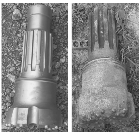
图 1 新锤头与断裂锤头对比
