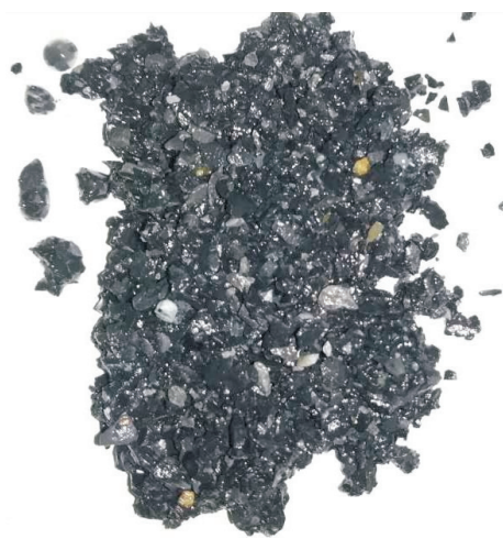
图 4 SC86H 型高能射流式液动潜孔锤钻进产生的灰岩岩屑
