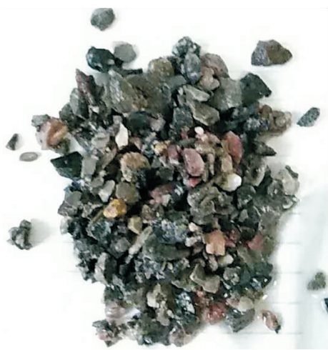
图 3 液动潜孔锤孔口动作试验时破碎的砾石岩屑
