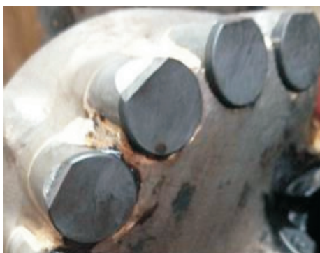
图 4 M1665RJ PDC 钻头出井照片
