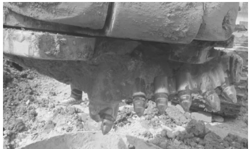
图3 改进后钻斗底部的结构形式
