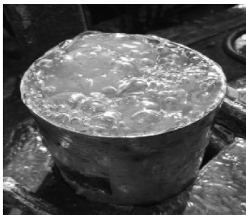
图2 钻进过程中钻孔涌水涌气
