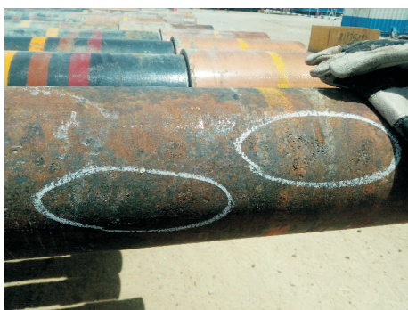
图3 本体不合格的 \text{O}168.3 \text{ mm} 尾管
