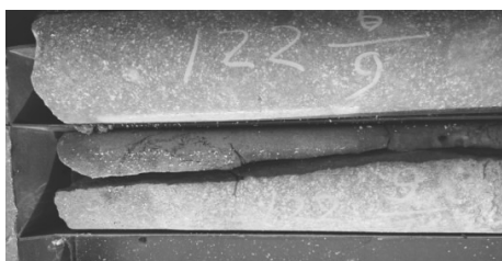
(a) ZKN901井部分漏失地层岩心
