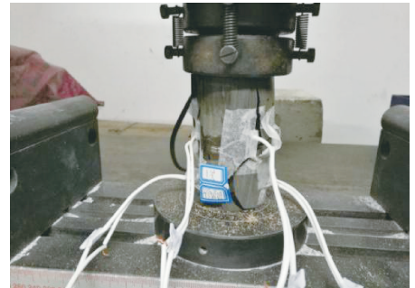
图 2 平行层理方向单轴压缩变形实验
