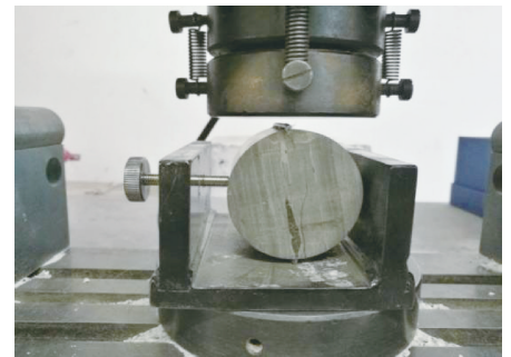
图 3 劈裂抗拉强度实验
