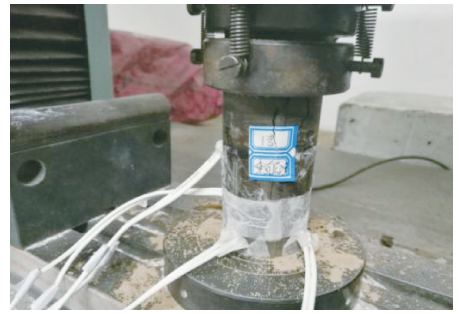
图 1 垂直层理方向单轴压缩变形实验
