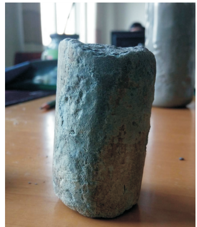
图 8 钻取的化学凝胶堵漏材料岩心柱
