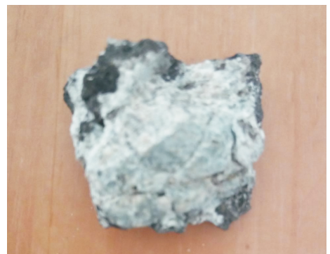
图 9 凝胶与固相材料胶结情况
