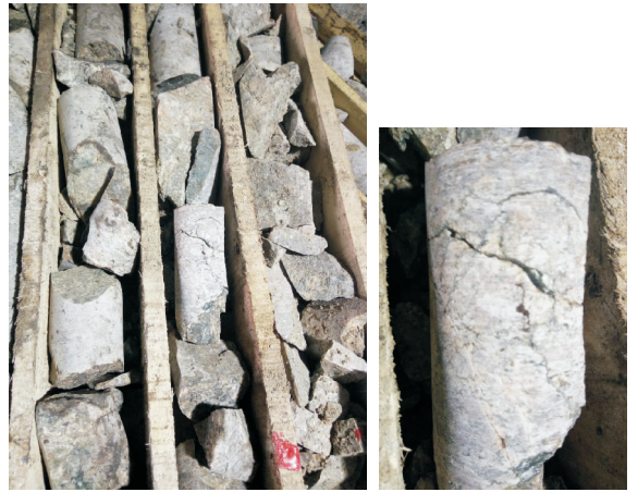
图 3 漏失地层岩心 Fig.3 Core of leakage formation
