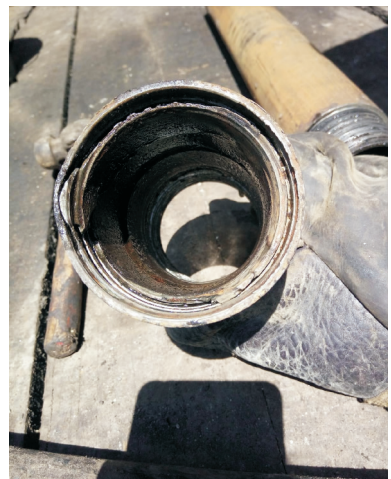
图 4 断钻事故 Fig.4 Broken drill pipe accident
