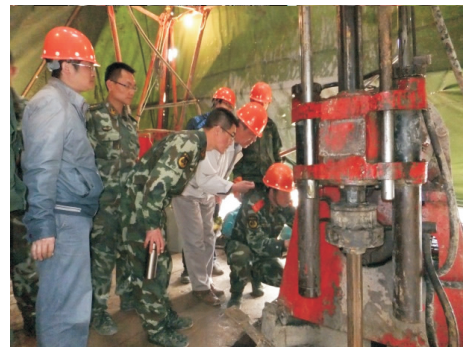
图11 阳山金矿区 ZK2132 孔现场纠斜试验
