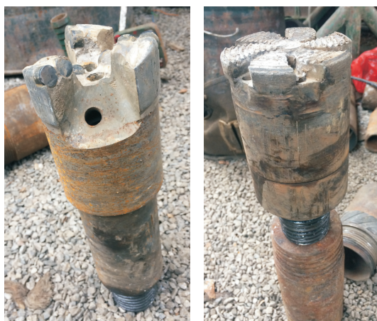
图 2 \varnothing 89 mm 无心钻头和平底钻头照片
