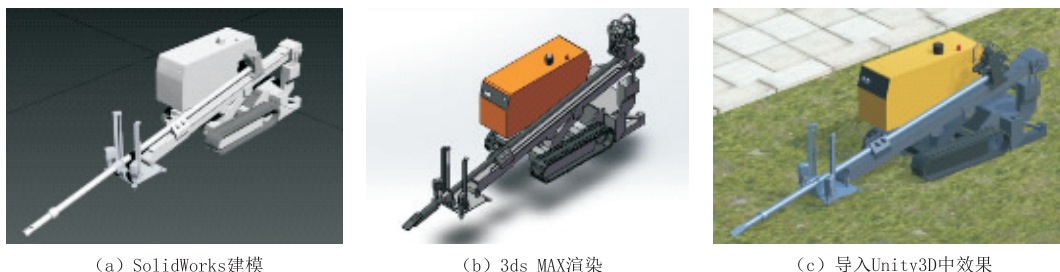
图5 HDD 钻机建模、渲染及其在 Unity3D 中的效果
