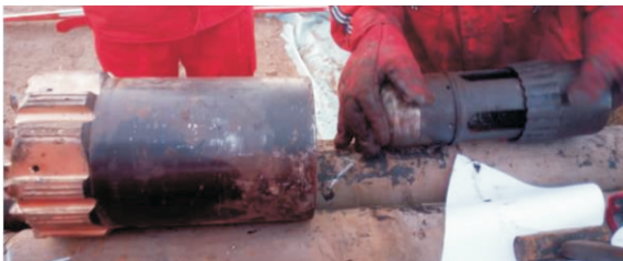
图 2 装配密封活塞与取心钻头
