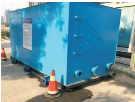
图4 集水沉淀箱 Fig.4 Precipitation tank
