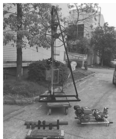
图1 CBQ-30A型轻便取样钻机 Fig.1 CBQ-30A portable sampling rig
