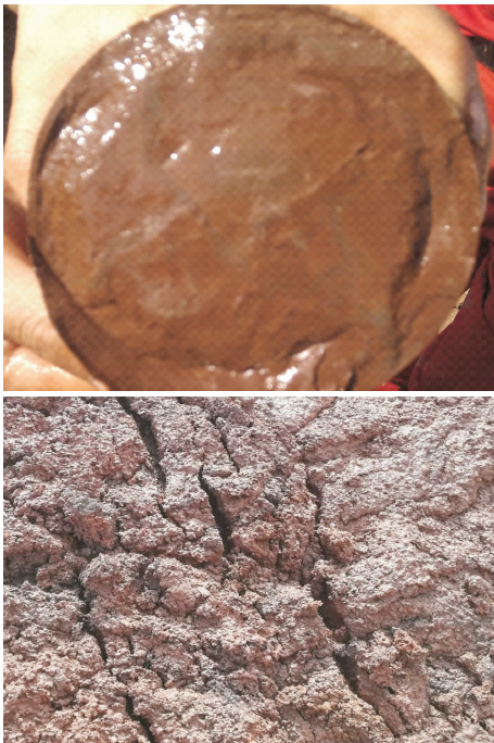
图 3 新近系红色泥岩岩心及岩样
