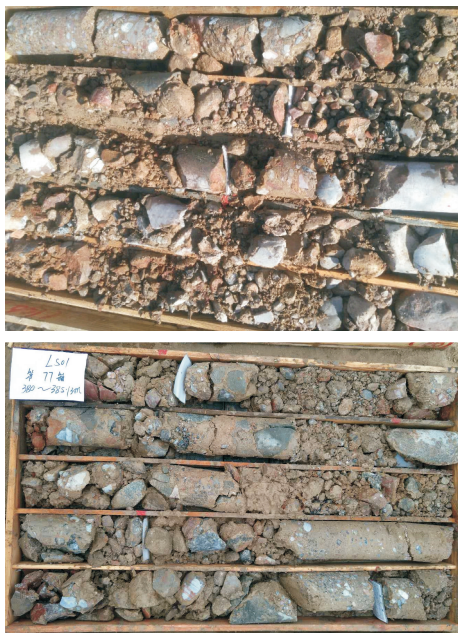
图 4 破碎砾岩地层岩心照片
