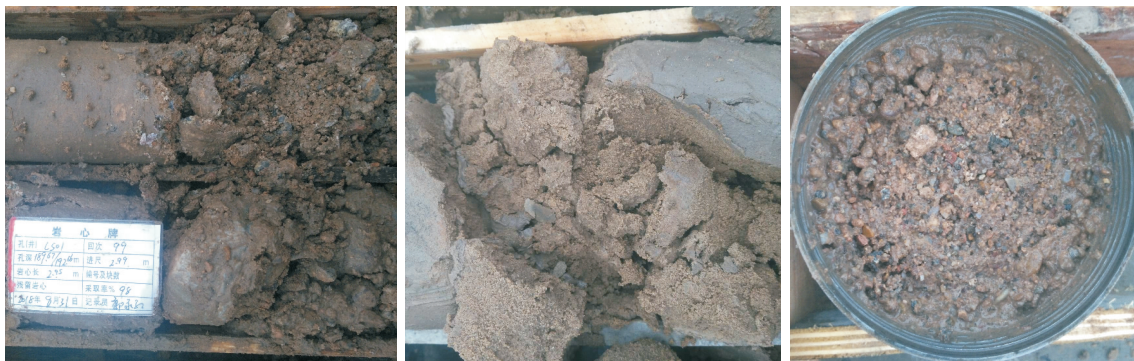
图2 砾石—细砂—中砂—粗砂互层岩心
