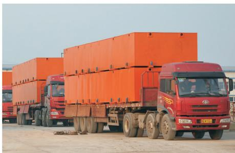
图 16 托盘车运输平台模块
