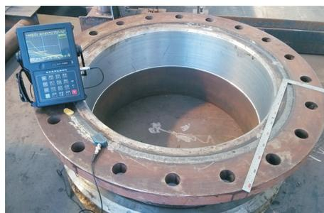
图 12 对法兰进行超声波探伤
