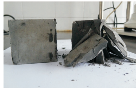
图9 水泥石性能对比(左:弹性水泥石;右:常规水泥石)
