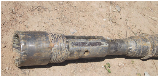
图1 组合加工成的简易内管总成打捞工具
