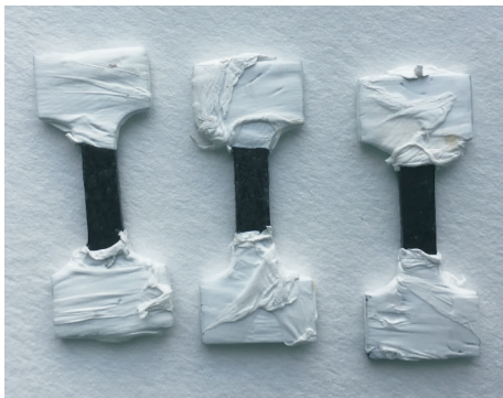
图1 两端包裹的预腐蚀铝合金拉伸试样
