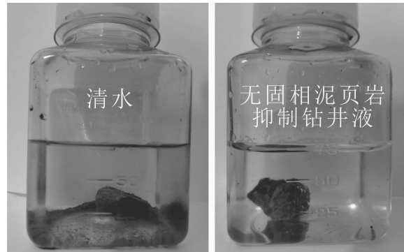
图2 浸泡45 min后无固相钻井液对泥页岩抑制性效果
