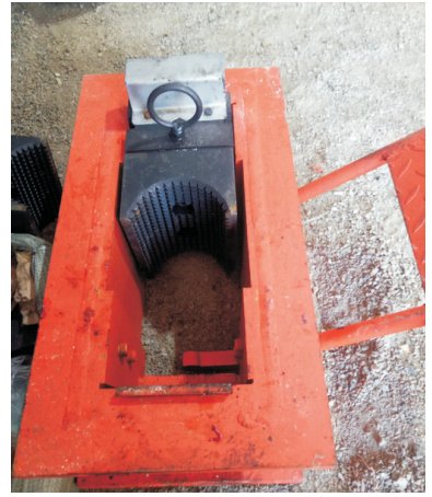
图7 与钻杆接触面积增大的卡瓦
