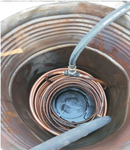
图6 加长油路水冷降温
