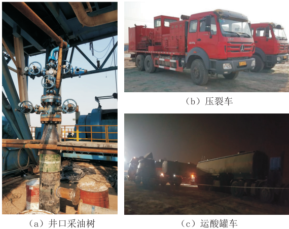
图 4 酸化洗井作业主要设备
