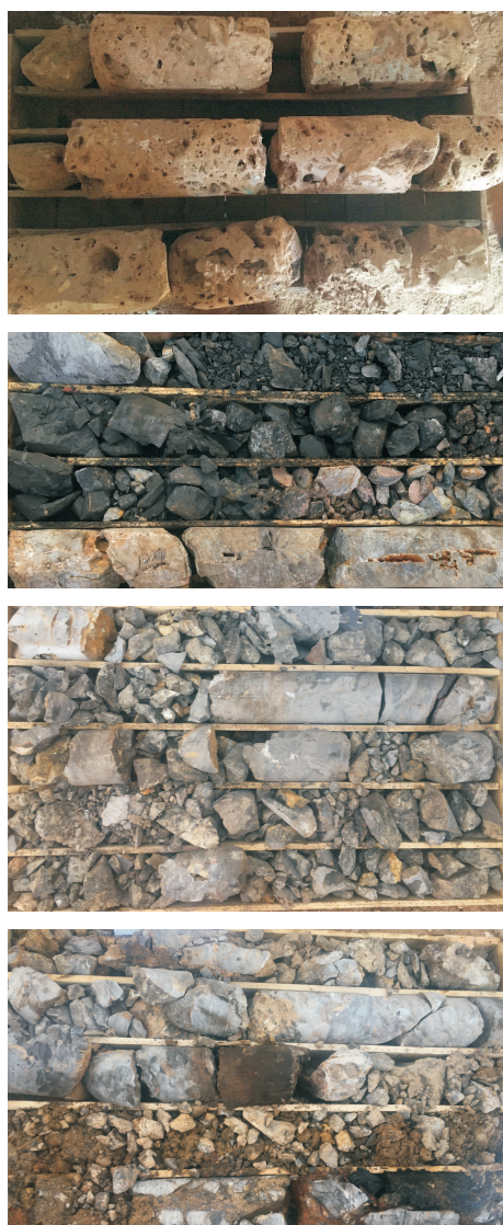
图 6 孔洞、裂隙、破碎、坍塌处岩心实物图
