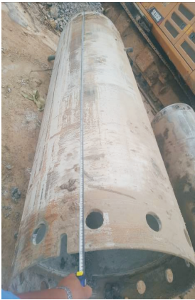
图 2 外护筒标准节 Fig.2 Standard section of outer casing
