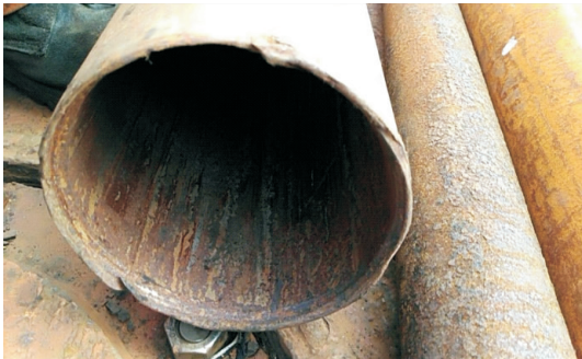
图 5 切口整齐的套管 Fig.5 Neatly cut casing
