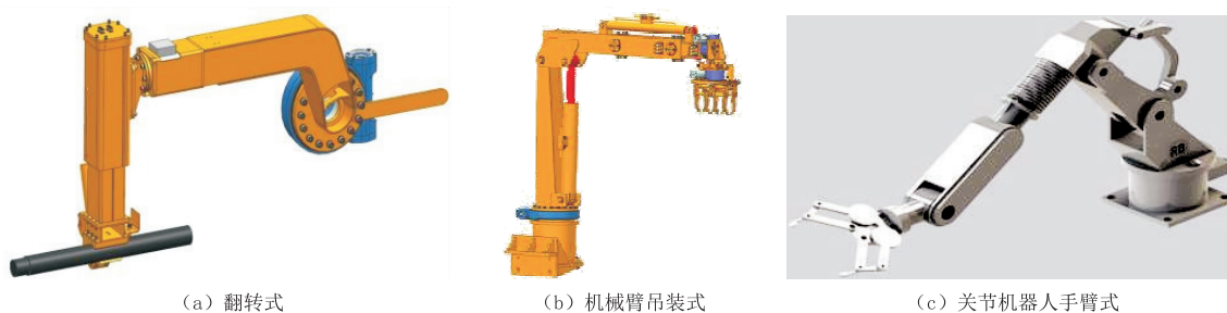
图 4 加卸钻杆装置结构示意图
