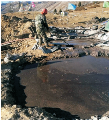
图2 地质钻探废弃冲洗液露天存放
