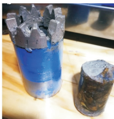
图 12 钻取的冰下基岩岩心及基岩钻头 [62]
