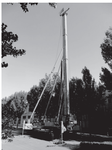
图 1 LGZ-40 型全液压多功能桩机 Fig.1 LGZ-40 hydraulic multifunctional pile drilling rig
