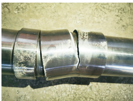
图 11 手动拧紧试件断裂情况
