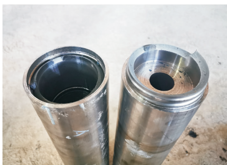
图 12 上扣扭矩拧紧试件断裂情况
