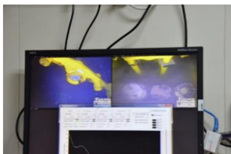
图 5 海底基盘可视摄像系统画面传输至甲板
