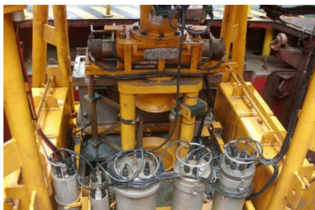
图 4 海底基盘液压钳与多种监测器
