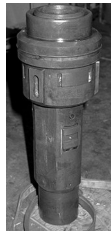
图 6 跟管钻进下套管用套管送入工具
