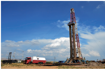
图8 SKD-3000B型测井车测温
