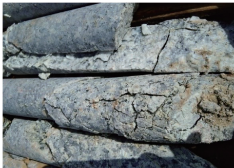
图 3 裂隙发育地层岩心
