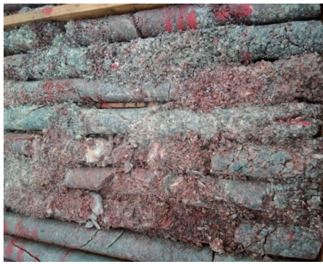
图 1 水敏性蚀变地层岩心
