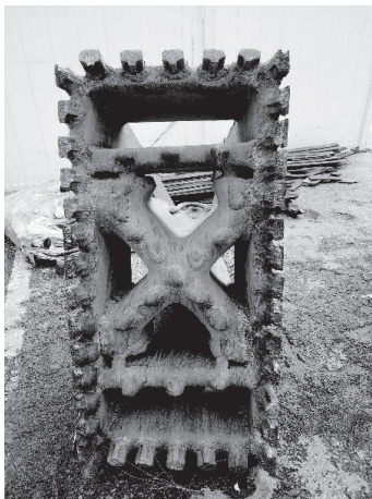
图2 改造的方形锤头底部
