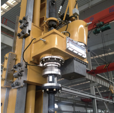
图6 转速传感器和复合压扭传感器安装位置
