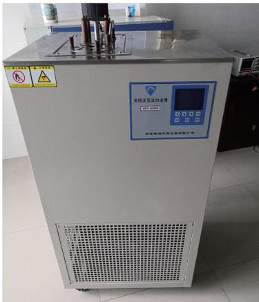
图4 恒温油槽
