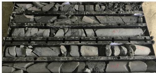
图1 某隧道勘察岩心
