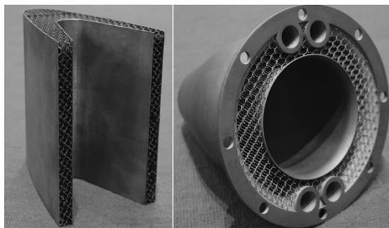
图4 飞机用激光选区熔化制造金属多功能点阵结构
