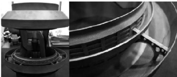
图 5 增材制造技术制备 RS-25 火箭发动机弯曲接头
