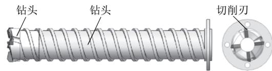
图 7 一种空心螺旋取心钻具
