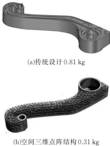
图 6 采用不同优化设计方法的结构
