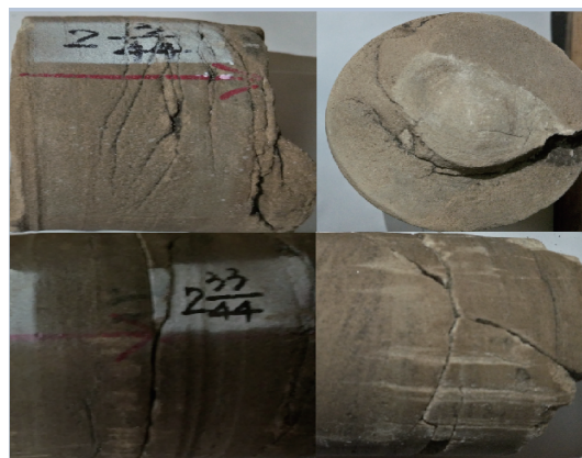
图2 柯坪塔格组岩心裂缝
