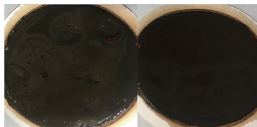
(a) 未加微纳米封堵剂 (b) 加入微纳米封堵剂
